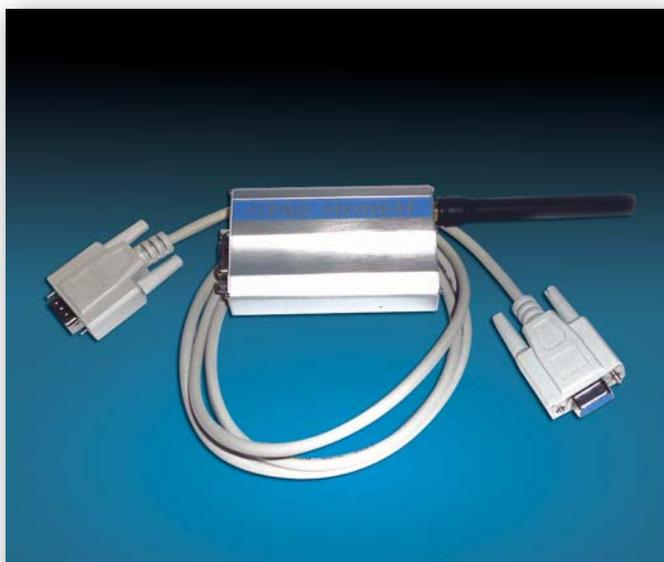
Il modem PV-MDM viene fornito completo di alimentatore 9V/100...240V AC e di cavo RS232 per collegamento al Logger
