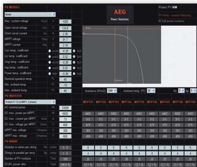
Il software di configurazione PV AIM è uno strumento semplice e pratico per la configurazione di campi fotovoltaici da abbinare agli inverter AEG Protect PV. Si tratta di un applicativo JAVA che funziona su Internet Explorer e che contiene una libreria di moduli alla quale si può accedere per la configurazione delle stringhe.
