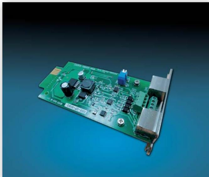
La scheda di comunicazione PV-RS può essere installata in tutta la serie di inverter Protect PV (già inclusa su PV25 e PV33), tramite il semplice inserimento nella slot dedicata, anche con inverter in funzione.
